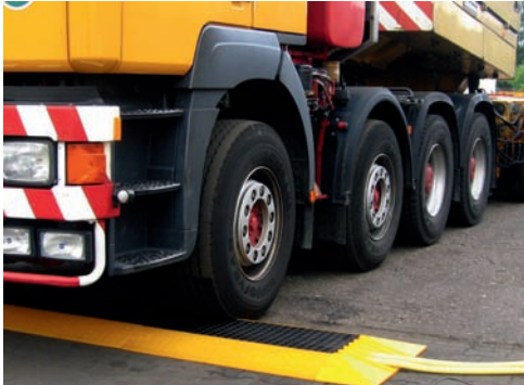
Abb. 5 Kabelbrücke aus hoch belastbarem Material
