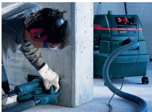
Abb. 14 Mauernutfräse mit Staubabsaugung
